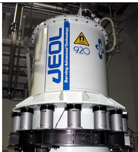
図 1 分子科学研究所において稼動している 920MHz NMR 分光器
