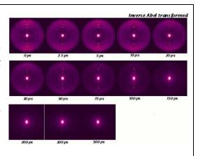
分子軸が実験室系に対して為す角度が時々刻々と変化する為に、光電子の放出角度分布が変化する。このような時間発展の解析から、分子や電子軌道の形状といった立体化学(stereo dynamics)が解明できる。また、電子軌道の変化による電子エネルギー変化、あるいは分子内振動エネルギーのモード間エネルギー移動が起こった場合には、光電子エネルギー分布が時間と共に変化するため、画像から容易に検出できる。時間分解光電子分光は、試料濃度の薄い気体分子やクラスターなどの励起状態ダイナミックス(反応・内部転換・項間交差・振動エネルギー再分配)を追跡する目的では決定的に有効な手段である。
