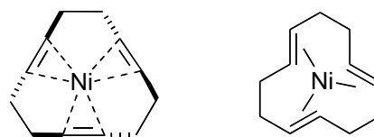
図1. ブタジエンの三量化によるシクロソドデカトリエン合成におけるニッケル錯体中間体（プロペラ型）
