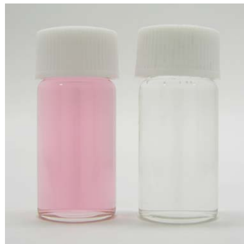
図 2 金微粒子の水安定分散液（左）を、加圧下 350 °C で加熱すると、速やかに粒子が凝集・沈殿し、ルビー色が消失する（右）
