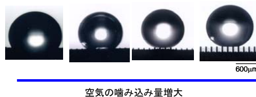
図1：表面粗さの増大に伴う空気のかみこみ量の増大と撥水性の強調
